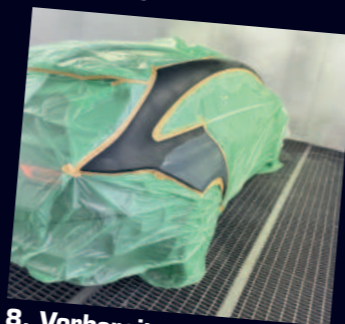
8. Vorbereitung zur Lackierung in der Überdruck-Spritzkabine
