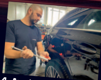
4. Ausrichten der beschädigten Flächen ohne Schweißarbeiten, um den Korrosionsschutz nicht zu beschädigen
