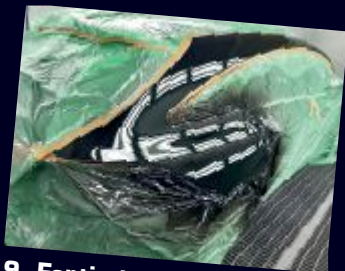
9. Fertig lackiertes Bauteil beim Trocknen in der Einbrennlackierung
